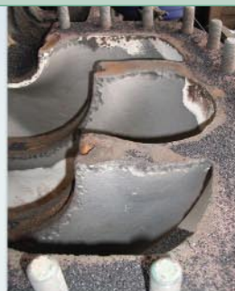
A gödrösödés és az erózió egyértelműen látható
